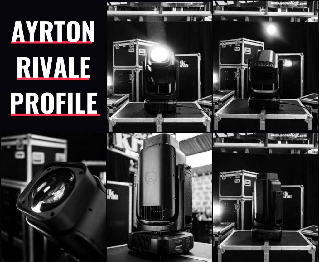
Premier luminaire ultra-équipé de la série “ULTIMATE” d'AYRTON, la RIVALE PROFILE a été conçu pour une utilisation en intérieur comme en extérieur. Équipé d'un tout nouveau module LED monobloc étanche à haut rendement de 430 watts, calibré à 6500 K, elle offre un flux lumineux de 30 000 lumens. L'ergonomie du projecteur comme son poids de 27kg ainsi que l'ensemble des ses caractéristiques garantisse une polyvalence à tout niveaux.
